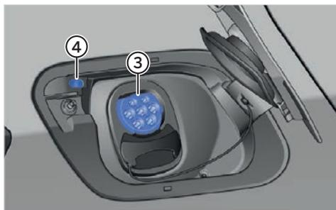
Rimuovere il cavo di ricarica dalla stazione di ricarica e collegarlo al connettore del veicolo "3". Chiudere l'auto con la carta Mobility (posizionarla sul checkpoint). Il processo di ricarica si avvia automaticamente; se necessario, attivare la stazione di ricarica con la "carta di ricarica home". Controllare il LED "4" del connettore del veicolo. Se lampeggia (verde), l'auto si sta caricando correttamente.
