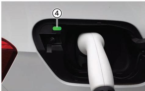
Se il processo di ricarica è stato avviato correttamente, il LED "4" del connettore del veicolo lampeggia (verde). Si prega di controllare.
