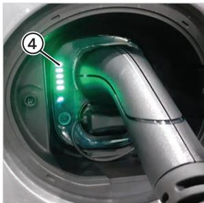
Ist der Ladevorgang korrekt gestartet, blinkt die höchste LED "4". Kontrollieren Sie dies.
