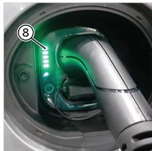
Nehmen Sie das Ladekabel von der Ladestation und schliessen Sie dieses am Fahrzeuganschluss "6" an. Schliessen Sie den Wagen mit der Mobility-Karte ab (Karte an Checkpoint halten).
