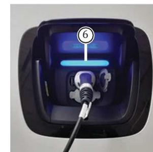
Prenez le cordon se trouvant sur la borne de recharge et branchez-le sur la prise de votre véhicule. Verrouillez le véhicule avec la carte Mobility (en la plaçant sur le checkpoint).
