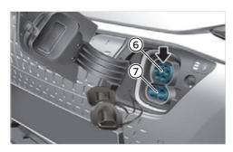
Nehmen Sie das Ladekabel von der Ladestation und schliessen Sie dieses am Fahrzeuganschluss "6" an. Schliessen Sie den Wagen mit der Mobility-Karte ab (Karte an Checkpoint halten). Der Ladevorgang startet automatisch. Kontrollieren Sie dies am Symbol "Batterie" des Fahrzeuganschlusses. Dieses muss grün blinken, falls das Auto ordnungsgemäss geladen wird.
