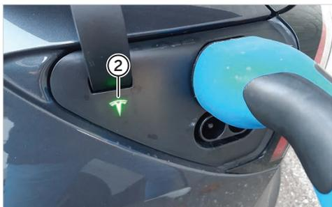
Ist der Ladevorgang korrekt gestartet, blinkt die LED "2" grün. Kontrollieren Sie dies.
