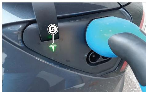
Nehmen Sie das Ladekabel von der Ladestation und schliessen Sie dieses am oberen Fahrzeuganschluss an. Schliessen Sie den Wagen mit der Mobility-Karte ab (Karte an Checkpoint halten).
