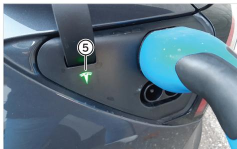
Prenez le cordon se trouvant sur la borne de recharge et branchez-le à la prise supérieure de votre véhicule. Verrouillez le véhicule avec la carte Mobility (en la plaçant sur le checkpoint).
