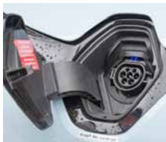
Clapet de charge à l'avant de la voiture
