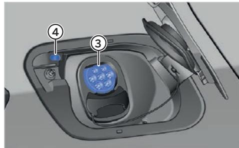
Nehmen Sie das Ladekabel von der Ladestation und schliessen Sie dieses am Fahrzeuganschluss "3" an. Schliessen Sie den Wagen mit der Mobility-Karte ab (Karte an Checkpoint halten).
