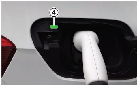
Ist der Ladevorgang korrekt gestartet, leuchtet die LED "4" am Fahrzeuganschluss grün. Kontrollieren Sie dies.
