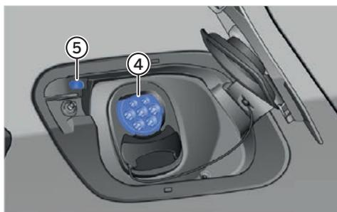
Prenez le cordon se trouvant sur la borne de recharge et branchez-le sur la prise "4" de votre véhicule. Verrouillez le véhicule avec la carte Mobility (en la plaçant sur le checkpoint). La recharge de la batterie démarre automatiquement. Sinon, activez la borne de recharge à l'aide de la carte "Home". Vérifiez que la LED "5" située près de la prise du véhicule clignote en vert: cela indique que la batterie se recharge correctement.
