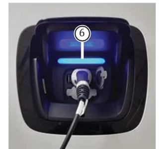
Nehmen Sie das Ladekabel von der Ladestation und schliessen Sie dieses am Fahrzeuganschluss an. Schliessen Sie den Wagen mit der Mobility-Karte ab (Karte an Checkpoint halten). Der Ladevorgang startet automatisch. Kontrollieren Sie dies an der LED "6" des Fahrzeuganschlusses. Dieses muss blau blinken, falls das Auto ordnungsgemäss geladen wird.
