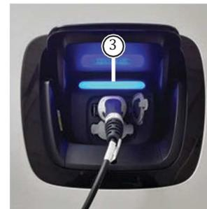
Se il processo di ricarica è stato avviato correttamente, il LED blu «3» lampeggia. Si prega di controllare.
