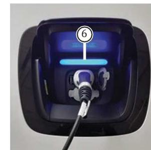
Rimuovere il cavo di ricarica dalla stazione di ricarica e collegarlo al connettore del veicolo. Chiudere l'auto con la carta Mobility (posizionarla sul checkpoint).
