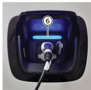
Nehmen Sie das Ladekabel von der Ladestation und schliessen Sie dieses am Fahrzeuganschluss an. Schliessen Sie den Wagen mit der Mobility-Karte ab (Karte an Checkpoint halten). Der Ladevorgang startet automatisch. Kontrollieren Sie dies an der LED "6" des Fahrzeuganschlusses. Dieses muss blau blinken, falls das Auto ordnungsgemäss geladen wird.
