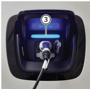
Ist der Ladevorgang korrekt gestartet, blinkt die LED blau "3". Kontrollieren Sie dies.
