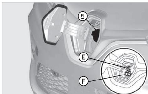
Nehmen Sie das Ladekabel von der Ladestation und schliessen Sie dieses am Fahrzeuganschluss "E" an. Der Ladevorgang startet automatisch oder schalten sie falls notwendig die Ladestation mit der "Home Ladekarte" frei. Kontrollieren Sie dies am Symbol "Z.E" des Fahrzeuganschlusses. Dieses muss blau blinken, falls das Auto ordnungsgemäss geladen wird. Schliessen Sie den Wagen mit der Mobility-Karte ab (Karte an Checkpoint halten).
