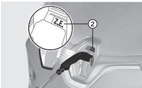
Ist der Ladevorgang korrekt gestartet, blinkt das Symbol "Z.E." blau (2). Kontrollieren Sie dies.
