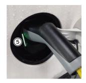
Nehmen Sie das Ladekabel von der Ladestation und schliessen Sie dieses am Fahrzeuganschluss "4" an. Der Ladevorgang startet automatisch oder schalten sie falls notwendig die Ladestation mit der "Home Ladekarte" frei. Kontrollieren Sie dies an der Ladevorgangsanzeige "5" des Fahrzeuganschlusses. Diese muss grün blinken, falls das Auto ordnungsgemäss geladen wird. Schliessen Sie den Wagen mit der Mobility-Karte ab (Karte an Checkpoint halten).
