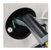
Ist der Ladevorgang korrekt gestartet, blinkt die Ladevorgangsanzeige "3" des Fahrzeuganschlusses grün. Kontrollieren Sie dies.
