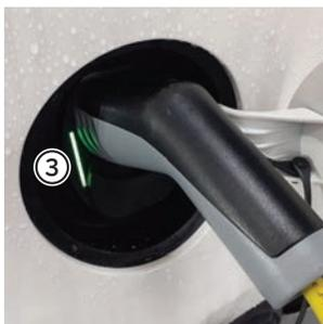
Se il processo di ricarica è stato avviato correttamente, l'indicatore di ricarica "3" lampeggia (verde).
