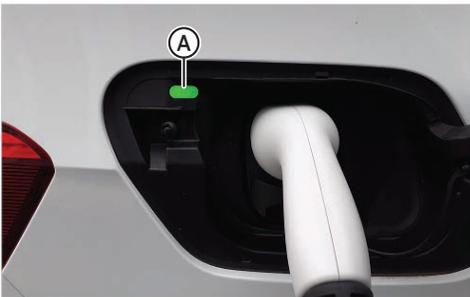
Ist der Ladevorgang korrekt gestartet, blinkt die LED "A" am Fahrzeuganschluss grün. Kontrollieren Sie dies.
