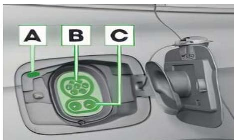
Rimuovere il cavo di ricarica dalla stazione di ricarica e collegarlo al connettore del veicolo "B". **Se presente, tenere la carta di ricarica "Home", che si trova nel portacarte del vano portaoggetti, davanti al punto di ricarica per avviare la ricarica.** Chiudere l'auto con la carta Mobility (posizionarla sul checkpoint). Il processo di ricarica si avvia automaticamente. Controllare il LED "A" del connettore del veicolo. Se lampeggia (verde), l'auto si sta caricando correttamente.
