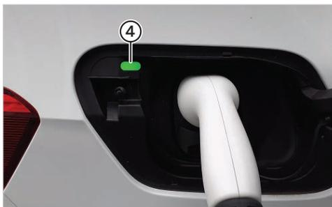
Se il processo di ricarica è stato avviato correttamente, il LED "A" del connettore del veicolo lampeggia (verde). Si prega di controllare.
