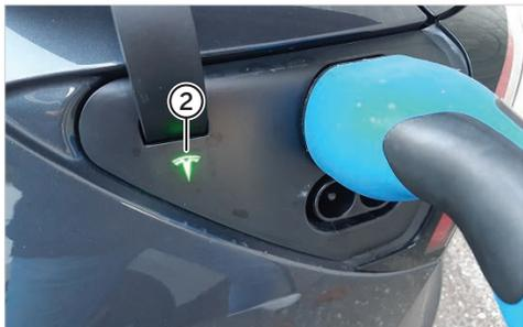
Se il processo di ricarica è stato avviato correttamente, il LED "2" lampeggia (verde). Si prega di controllare.
