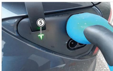
Rimuovere il cavo di ricarica dalla stazione di ricarica e collegarlo al connettore superiore del veicolo. Chiudere l'auto con la carta Mobility (posizionarla sul checkpoint). Il processo di ricarica si avvia automaticamente; se necessario, attivare la stazione di ricarica con la "carta di ricarica home". Controllare il LED "5" del connettore del veicolo. Se lampeggia (verde), l'auto si sta caricando correttamente.
