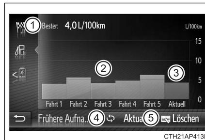
Die Bilanz des durchschnittlichen Kraftstoffverbrauchs ist nach Farben in Durchschnittswerte der Vergangenheit und dem Durchschnittsverbrauch seit der letzten Aktualisierung unterteilt. Verwenden Sie den angezeigten Durchschnittsverbrauch als Referenz.
